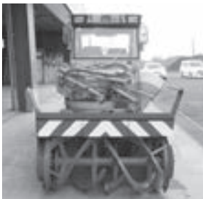
現在使用されているミニロータリー除雪車
