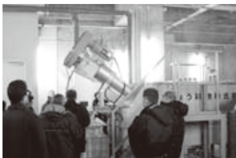
汚泥の中の異物を取り除く装置の説明を受ける。
